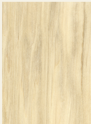
- kolor drewna kremowo biały do szarego. Mogą wystąpić brązowe plamy. Widoczny przekrój styczny.
