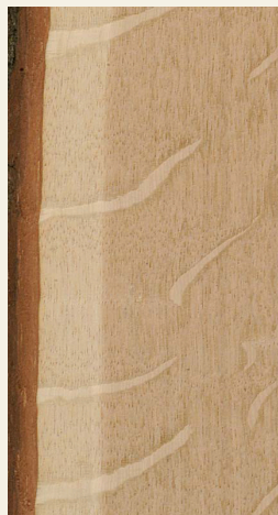
promienie rdzeniowe w postaci dużego błyszczu oraz biel – przekrój promieniowy
