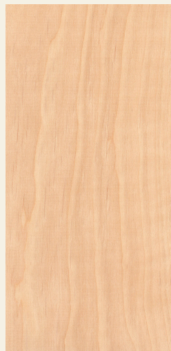
różowawy kolor i plamki rdzeniowe na przekroju stycznym
